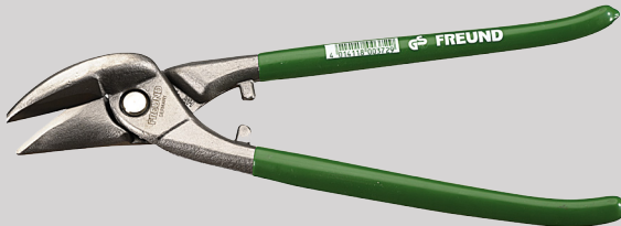
Idealschere/kombinierte Blechschere tauchisoliert, HRC 56 (grün)
