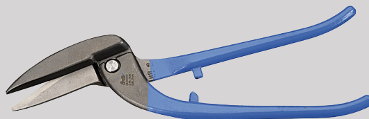
Tafelblechschere/Pelikanschere Edelstahl, HRC 59 (blau)
