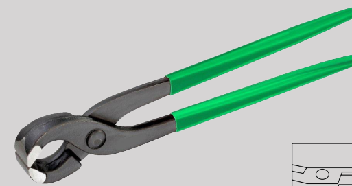
Universal-Klempnerzange für die Blechbearbeitung, Schenkelenden als Schraubendreher und Durchschlag verwendbar, Gewerbe eingelegt
